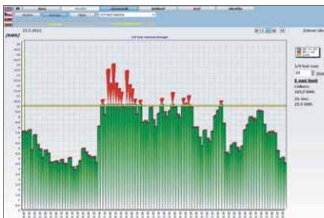
Obr. 9. Denní diagram činných energií dne 15. 5. 2012 s překročeními zvoleného limitu 10 kWh
