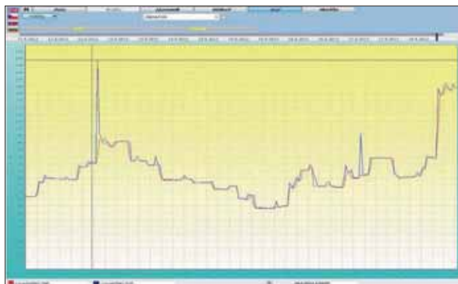
Obr. 7. Detail s maximálním desetiperiodovým proudem 148,4A dne 18. 5. 2012 v 6h 51m 20s
