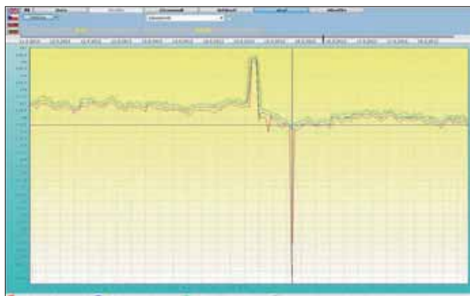
Obr. 4. Časový detail průměrného 10s napětí a krajních desetiperiodových napětí při události na napětí dne 16. 5. 2012 v 7h02m19s
